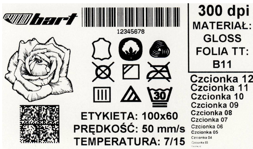
Etykieta wydrukowana z właściwą temperaturą pracy głowicy.
