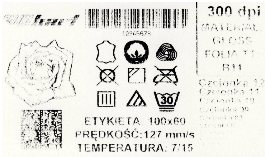
Etykieta wydrukowana ze zbyt wysoką prędkością.
