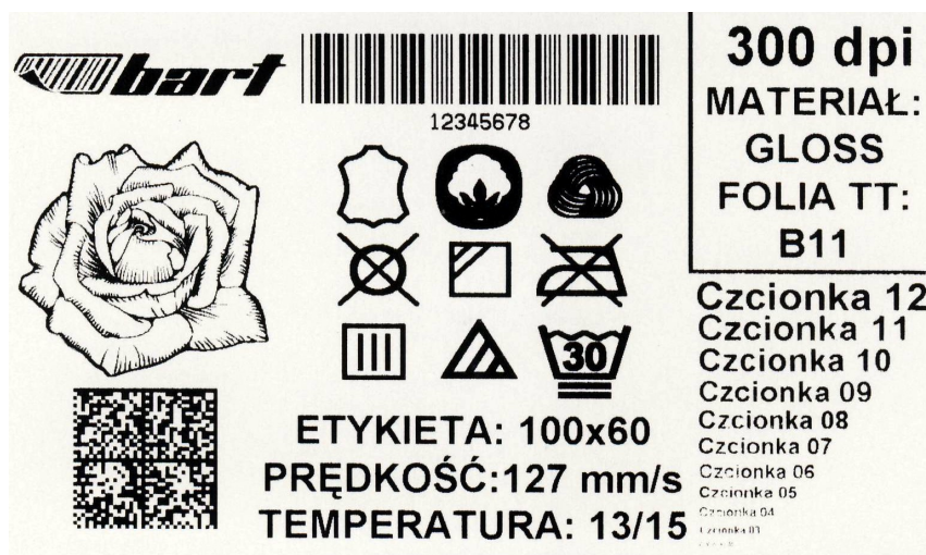
Etykieta wydrukowana z właściwą prędkością
