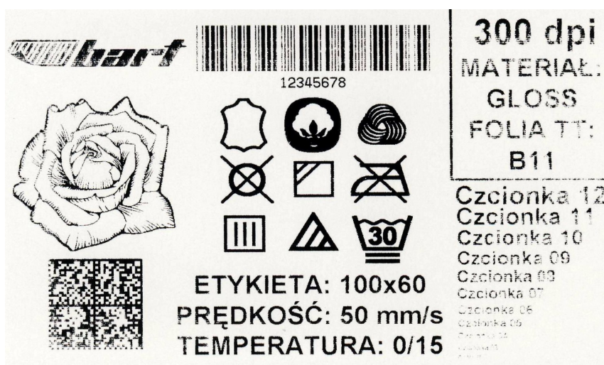
Etykieta wydrukowana ze zbyt niską temperaturą pracy głowicy.
